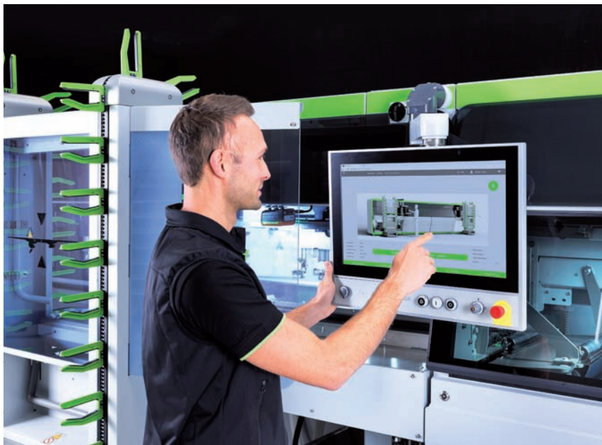
Modulárne intuitívne rozhranie Jupitera je založené na softvéri mapp View spoločnosti B&R.
