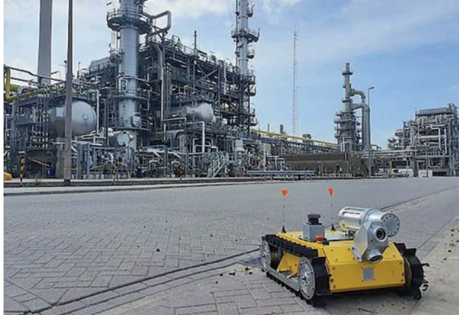
Robot ExR-1 vykonáva okružné jazdy s cieľom detegovať unikajúci plyn.
