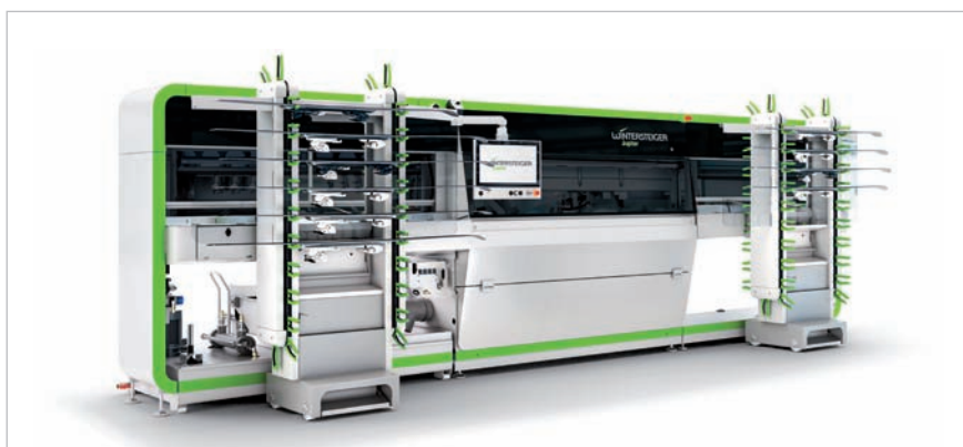
Zákazníci spoločnosti Wintersteiger si môžu nakonfigurovať vlastnú servisnú stanicu na nastavovanie lyží pozostávajúcu z dvoch až ôsmich modulov.
