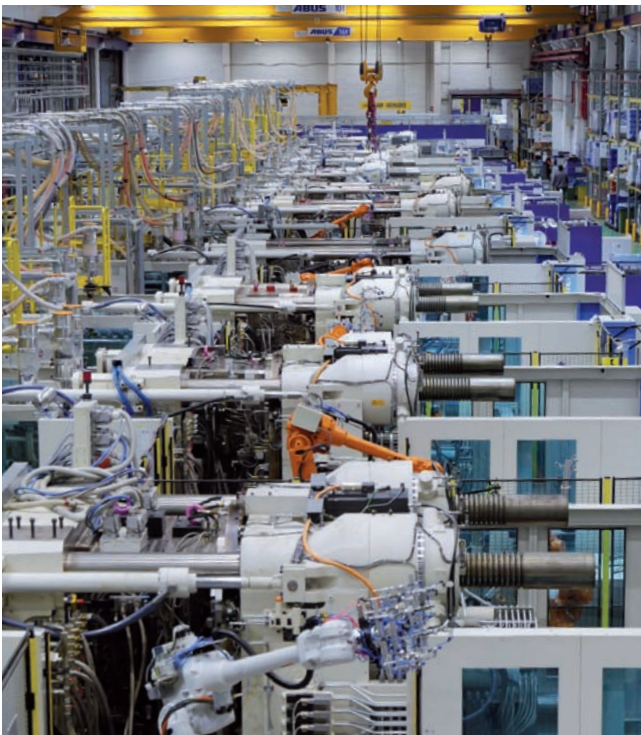
Vstrekolisý a roboty v závode HELLA Bánovce nad Bebravou (Zdroj: HELLA Slovakia Lighting s. r. o.)
