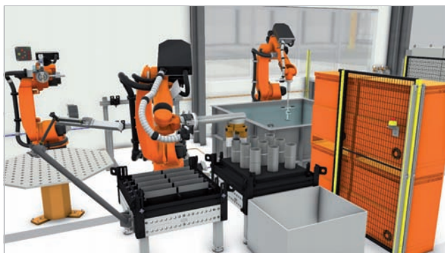
Obr. 1 Simulácia systému robotickej ultrazvukovej diagnostiky
