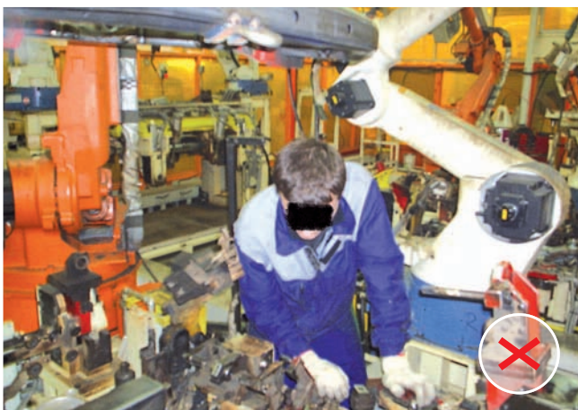
Obr. 6 Údržba vykonávaná počas chodu linky priamo v zóne nebezpečenstva
