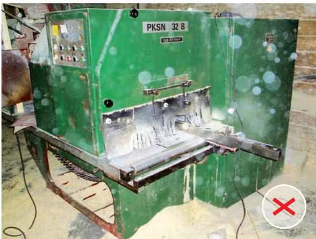
Obr. 8 Drevoobrábací stroj prevádzkovaný bez odsávacieho zariadenia
