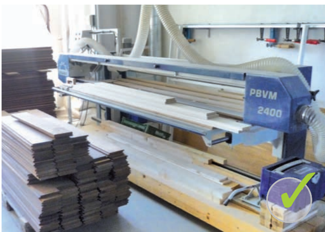
Obr. 9 Príklad drevoobrábacieho stroja s odsávacím zariadením
