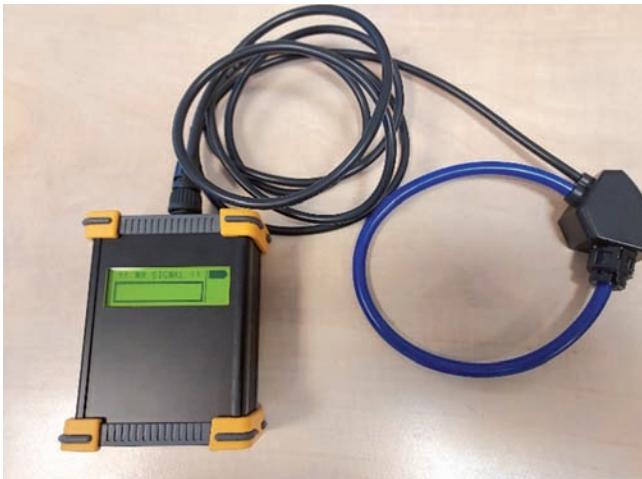
Obr. 3 Prijímač definovaného signálu RCS.01
