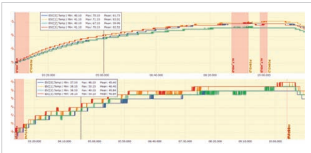
Obr. 1 Priebeh teploty meničov – pasívny chladič a uzavretá konštrukcia (hora), aktívny chladič a otvorená konštrukcia (dolu)
