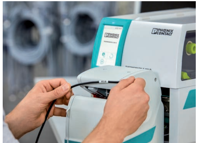
Obr. 3 Aplikátor Thermomark E.Wrap automaticky aplikuje označenie na valcové predmety. Ochranný laminát, ktorý pokrýva potlačený povrch, zabezpečuje obzvlášť odolné označenie.
